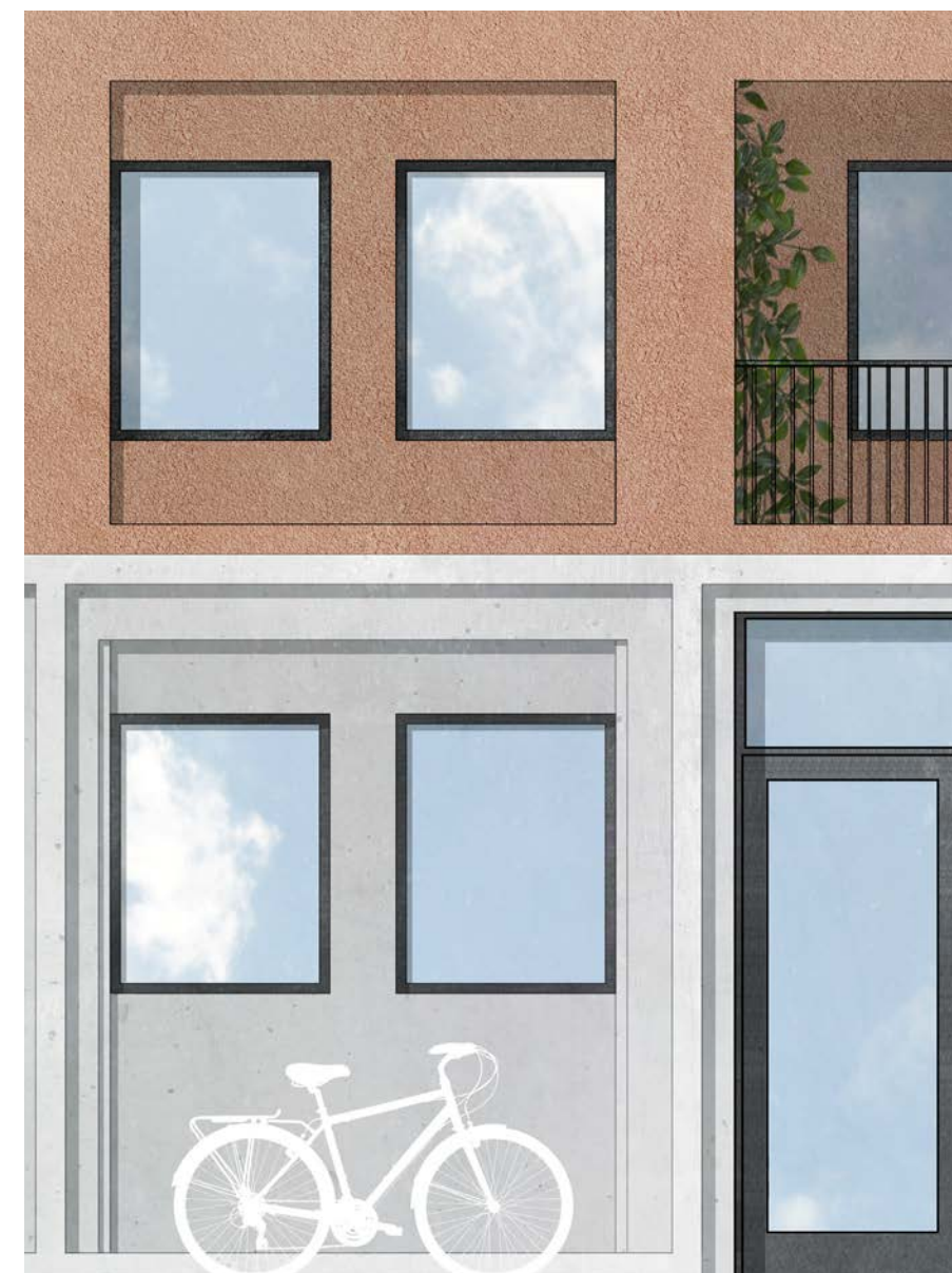
Exempel på markerad sockelvåning genom avvikande kulör och reliefverkan
