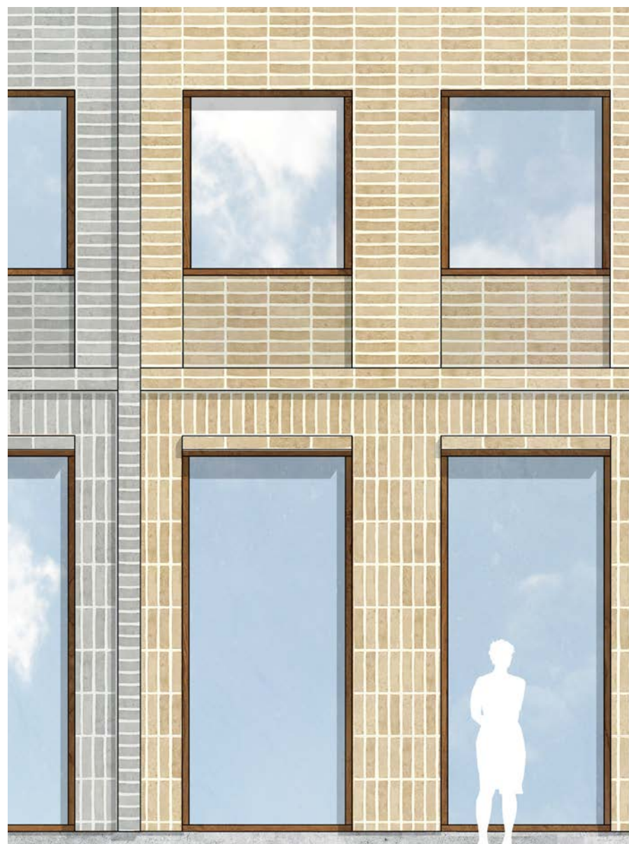
Exempel på markerad sockelvåning genom avvikande murförband, reliefverkan och stora fönsterpartier
